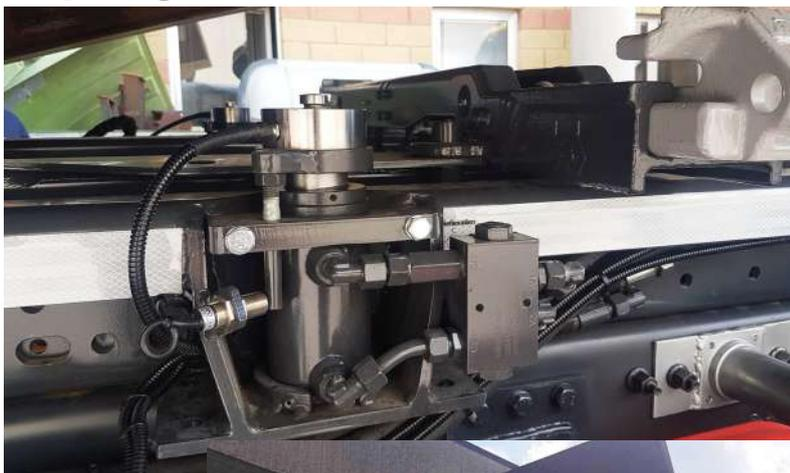
Le système prévoit l'installation de quatre vérins avec cellules intégrées qui en se soulevant détectent le poids (certifié) du matériel chargé dans le caisson.
