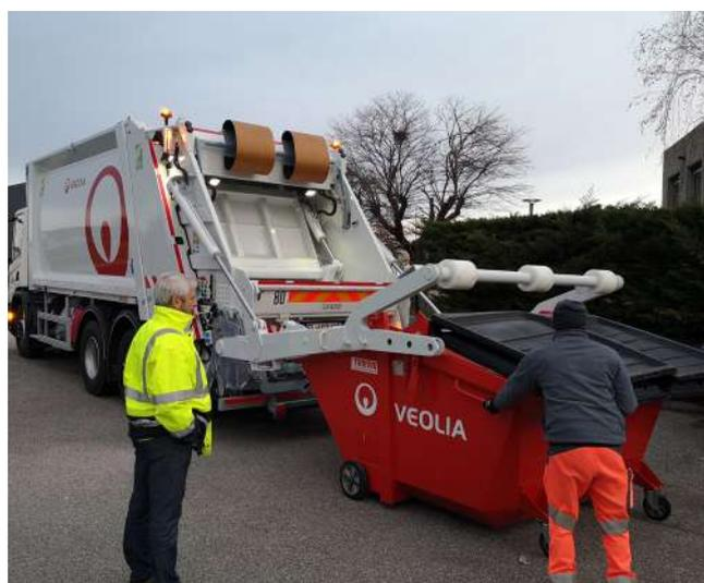
**LES CELLULES DE CHARGE DU SYSTÈME DE PESÉE SONT INSÉRÉES ENTRE LE CHASSIS ET LE FAUX CHASSIS DE L'ÉQUIPEMENT DU VÉHICULE.**
