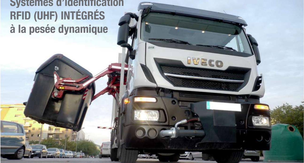
Systeme d'identification RFID : les antennes UHF sont installées sur l'équipement en proximité de la zone de vidage (ou sur le peigne du LC arriere pour les antennes LF).
